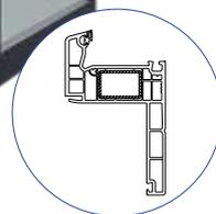
DORMANT RÉNOVATION AILE DE 32MM MOULURÉE
