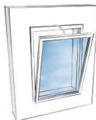
Egalement appelée soufflet, la fenêtre abattante s'ouvre en partie haute vers l'intérieur, sur un axe horizontal, grâce à un système de compas. Elle est adaptée aux petits espaces et offre une bonne aération de la pièce.
